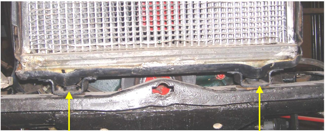
Sur ce type de radiateur il faut 2 caoutchoucs rectangulaire d'épaisseur 5 mm
